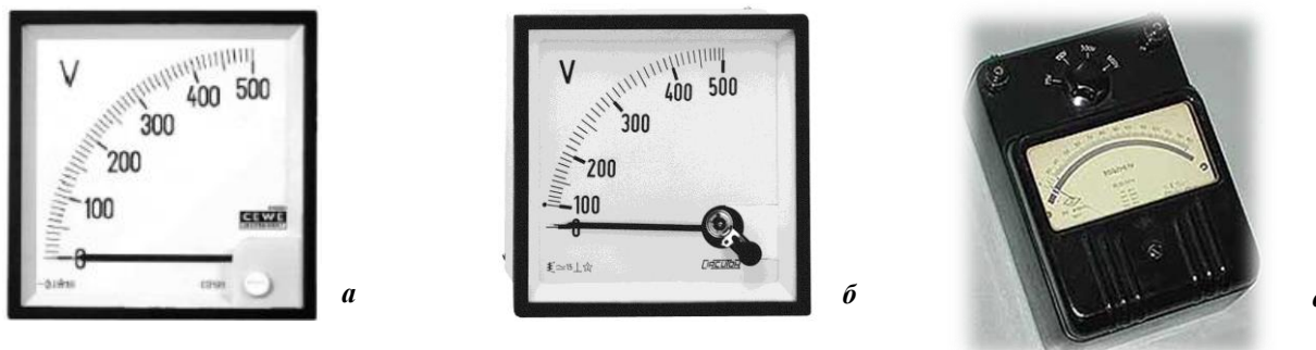
Рисунок 92 – Разновидности шкалы: а – равномерная; б – неравномерная; в – зеркальная
